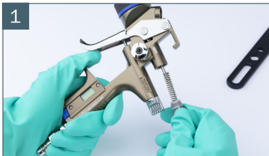
1 Al desmontar el juego de boquillas se saca primero la aguja de pintura.
