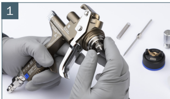
1 Montar la boquilla de pintura
