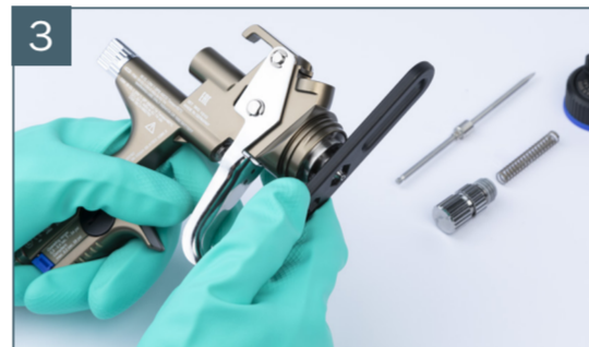
3 Al final, desatornillar la boquilla de pintura con la llave de anillo integrada en la herramienta universal.
