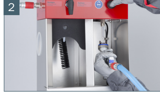
2 Secar la pistola y el conducto de pintura
