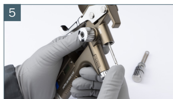
5 Montar la aguja de pintura
