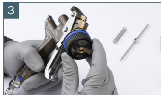
3 Montar la boquilla de aire
