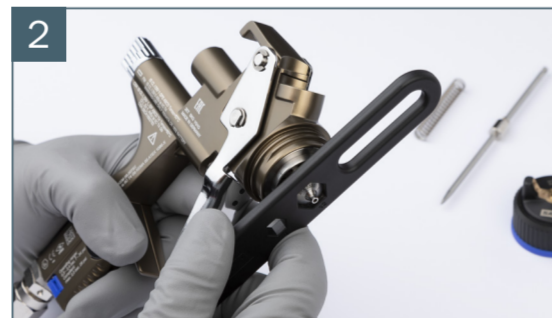
2 Atornillar robustamente la boquilla de pintura con la llave universal
