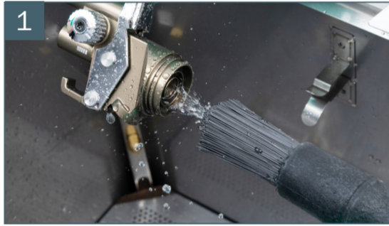
1 Limpeza del conducto de pintura
