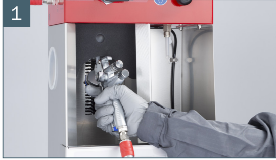
1 Limpiar y lavar el conducto de pintura y la boquilla de aire
