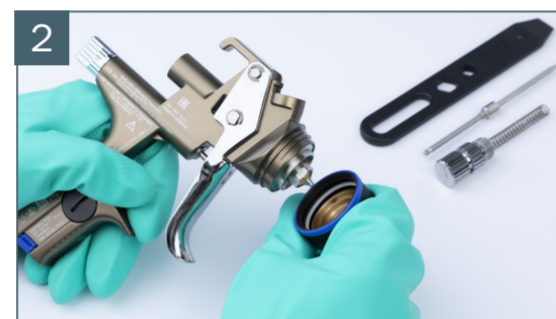
2 Dann erfolgt die Demontage der Luftpüse.
