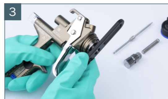
3 Zum Schluss wird mit dem im Universal-Werkzeug integrierten Ringschlüssel die Farbdüse ausge- schraubt.
