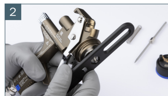
2 Farbdüse mit Universalschlüssel handfest anziehen
