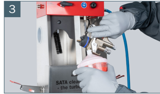
3 Nach nur ca. 25 – 30 sek. sind Farbwechsel durchgeführt
