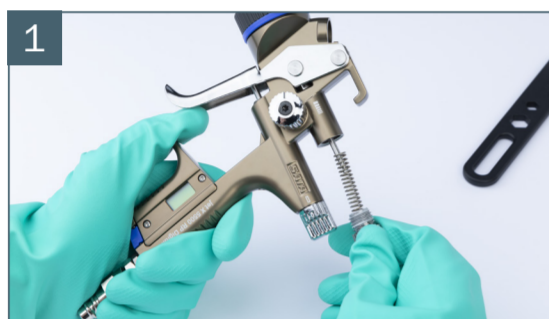
1 Beim Ausbau des Düsensatzes wird zuerst die Farbnadel herausgenommen.
