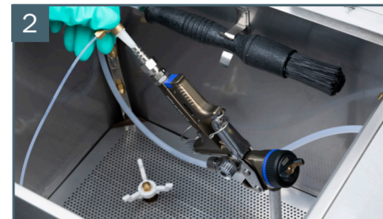
2 Luftanschluss an den Lufteingang anschließen
