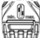
Τροχός ρύθμισης με ένδειξη της τρέχουσας ρύθμισης και ρύθμισης της ισχύος θέρμανσης ή ψύξης (min. = ελάχιστη ισχύς θέρμανσης ή ψύξης // max. = μέγιστη ισχύς θέρμανσης ή ψύξης).
