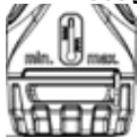
Rueda de regulación con indicación del ajuste de regulación actual y regulación de la potencia de calefacción o refrigeración (mín. = menor capacidad de calefacción o refrigeración // máx. = mayor capacidad de calefacción o refrigeración).
