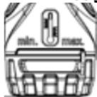
Reguleringshjul med indikation for den aktuelle reguleringsindstilling og regulering af varme- eller kølekapacitet
