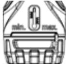
Регулиращо колело с индикация за текущата настройка на регулятор и за регулиране на отоплителната сътв. охладителна мощност (мин. = най-ниска отоплителна сътв. охладителна мощност // макс. = най-висока отоплителна сътв. охладителна мощност).
