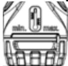
Regulačné koliesko s indikátorom pre aktuálne nastavenie regulácie a re-guláciu výkonu ohrievača, resp. výkonu chladenia
